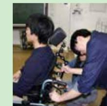
モジュラー型車椅子を用いて利用者の方々に適合させる技術を身につけるとともに、車椅子操作の実習を通じて、車軸の位置による影響や段差の乗り越え方などを学びます。
